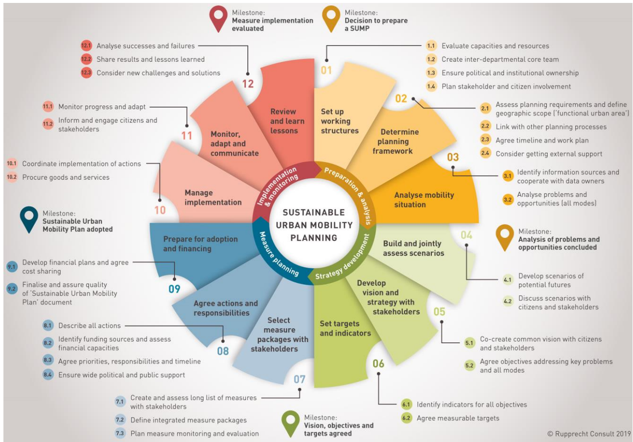
Figura 1.1 Ciclo di pianificazione per la realizzazione di un PUMS – Linee Guida ELTIS, 2019
