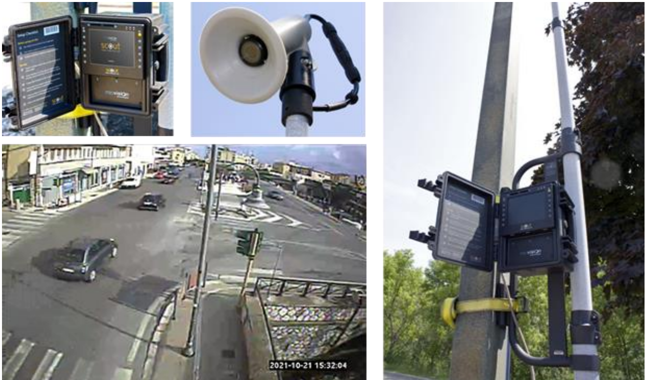
Figura 4.1 Il sistema Miovision per il rilievo dei flussi veicolari
