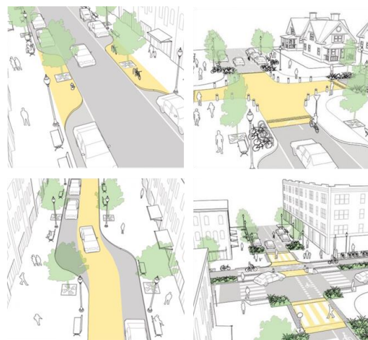
Figura 3.26 Esempificazione schematica di interventi di traffic calming
