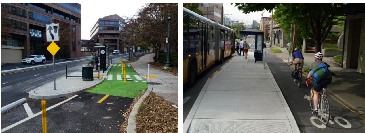
Figura 3.33 Esempi di risoluzione del conflitto tra pedoni e ciclisti alle fermate del trasporto pubblico Fonte: Adonis: "Best practice to promote cycling and walking" - 1998
