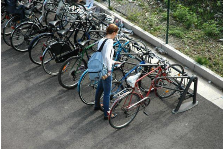
Figura 3.45 Esempio di rastrelliera per biciclette che permette il fissaggio di ruota e telaio
