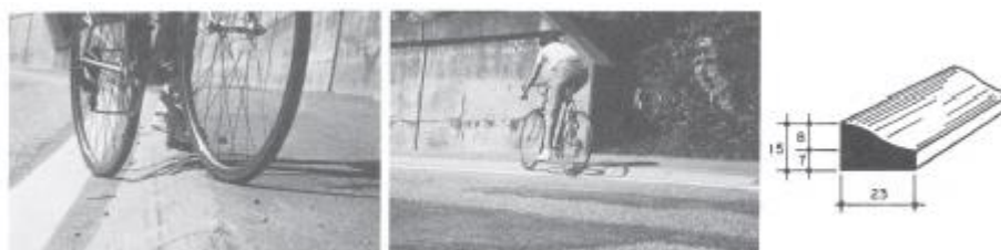
Figura 3.29 Esempio di utilizzo di cordonature che permettono al ciclista di salire e scendere dal marciapiede con facilità in caso di ostacolo o pericolo (“Amenagements à l’usage des deux-roues” - Cantone di Berna, Direction des travaux publics)
