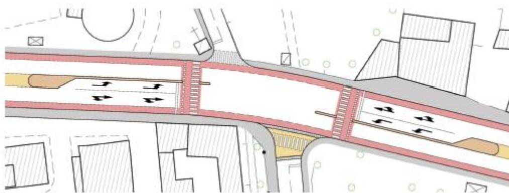
Figura 3.25 Esempio di continuazione della pista attraverso l'intersezione, realizzata con una banda colorata [Progetto per Sesto Fiorentino – Polinomia]
