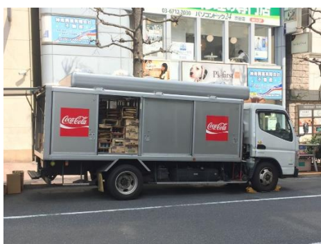
Figura 8.5 Giappone - furgone con cassone per il trasporto degli imballaggi separato da quello per il contenimento delle merci da consegnare
