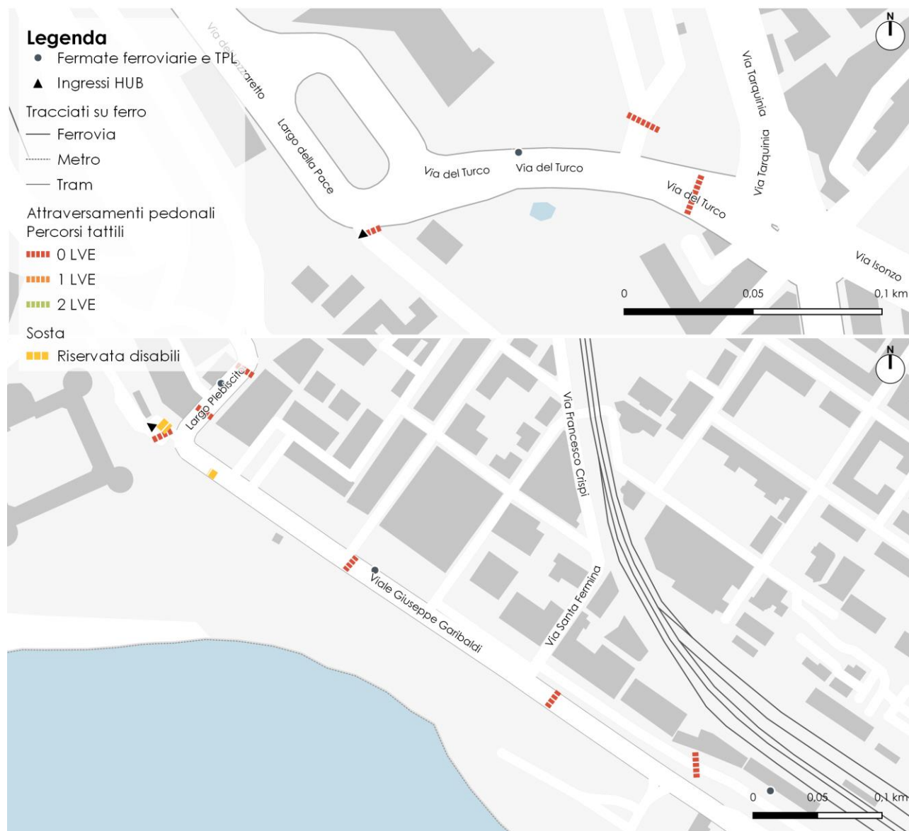
Figura 5.28 Attraversamenti pedonali differenziati per la presenza di dispositivi Loges Vet Evolution. Porto di Civitavecchia. Fonte: Elaborazione RTI
