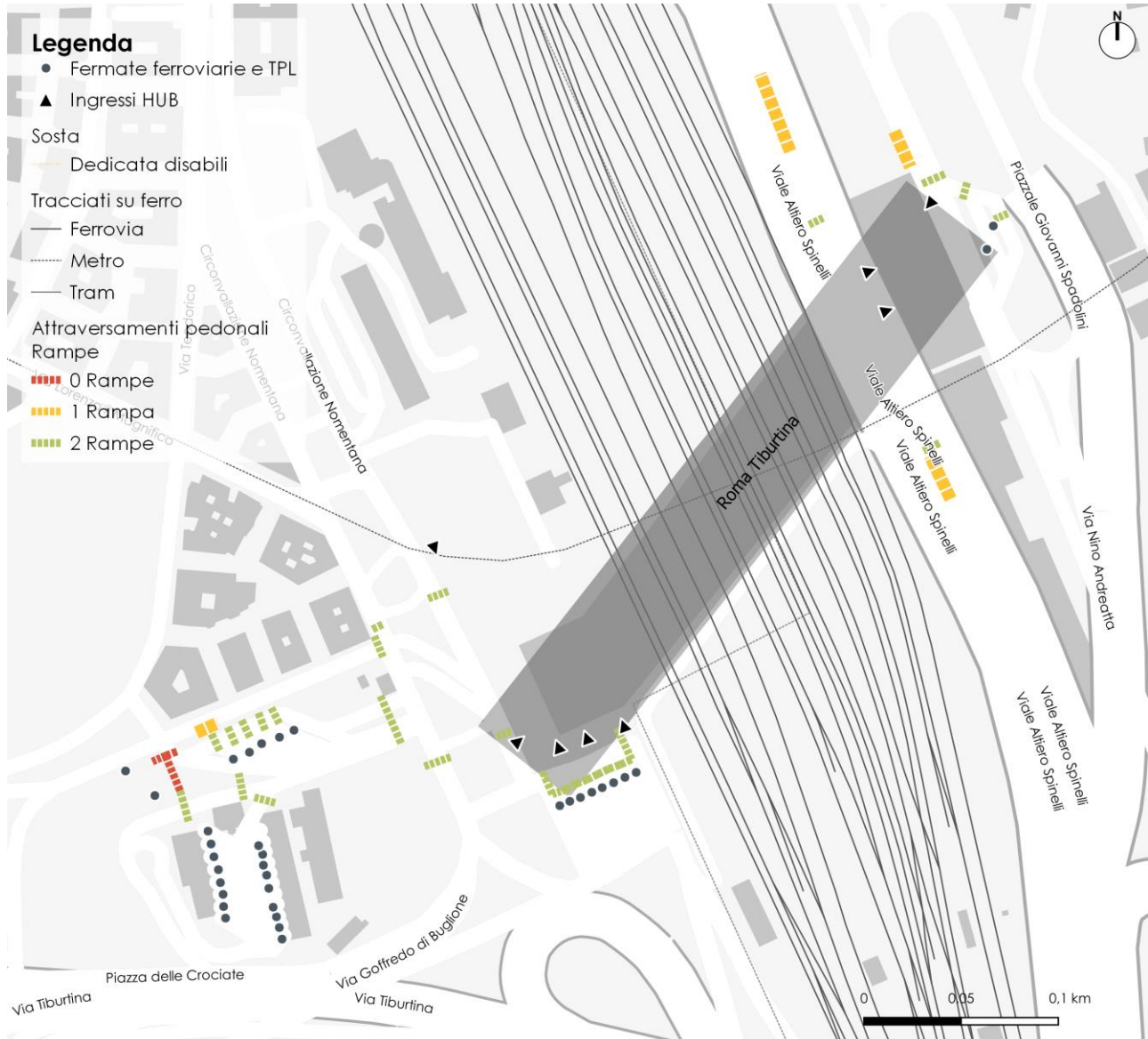
Figura 5.56 Attraversamenti pedonali differenziati per la presenza di rampe. Stazione di Roma Tiburtina. Fonte: Elaborazione RTI
