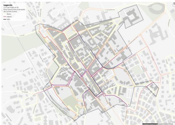
Figura 2.4 Analisi Space Syntax – Misura di “Choice” sulla rete ottimale
