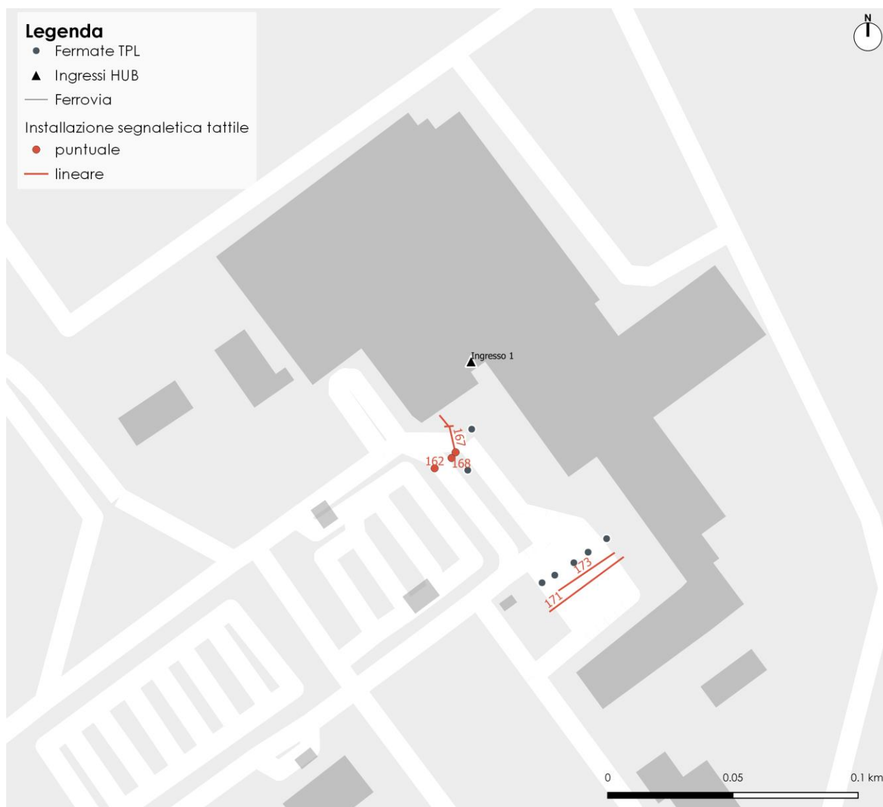
Figura 3.26 Riepilogo degli interventi proposti - Inserimento di segnaletica tattile di orientamento a terra adeguata presso l'HUB dell'Aeroporto di Ciampino. Fonte: Elaborazione RTI
