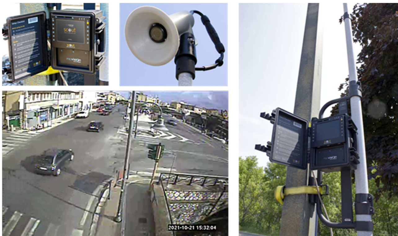
Figura 3.1 Il sistema Miovision per il rilievo dei flussi veicolari
