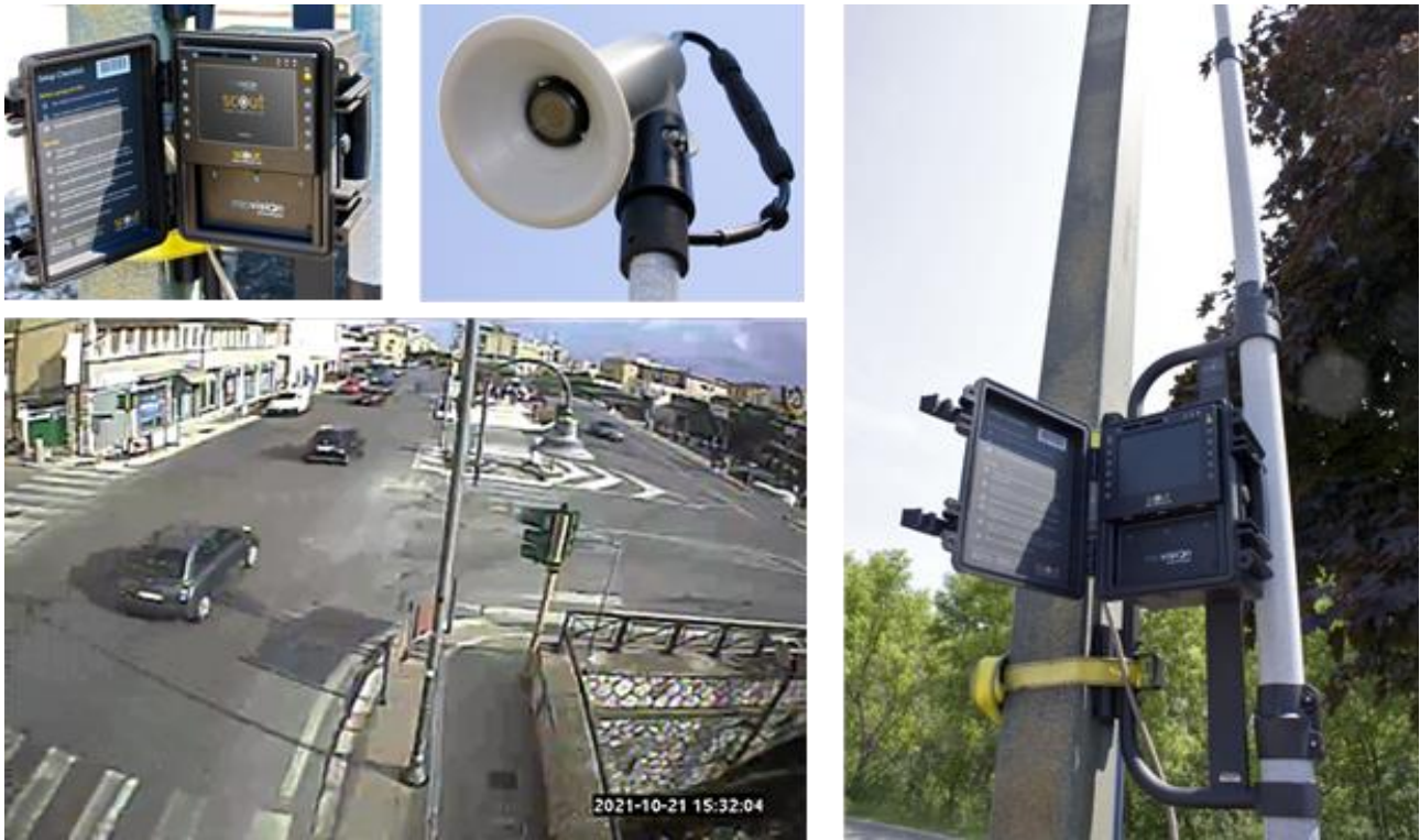
Figura 3.1 Il sistema Miovision per il rilievo dei flussi veicolari
