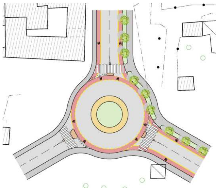
Figura 3.19 Esempio di inserimento di una pista ciclabile monodirezionale in una rotatoria con diametro di 28 metri: la corsia ciclabile può essere riportata direttamente in corona, senza tuttavia allargare la sede carrabile; tale indicazione infatti riveste sostanzialmente il significato di sottolineatura della presenza ciclabile e di segno di continuità dei percorsi. [Progetto per Sesto Fiorentino (FI) - Disegno Polinomia]
