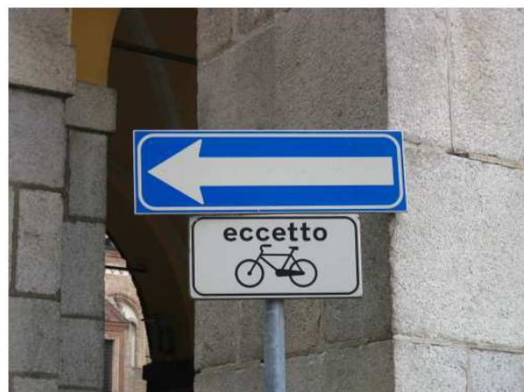
Figura 3.15 In alto a sinistra: segnaletica consigliata per legittimare la circolazione contromano delle biciclette su strade a senso unico di marcia. In alto a destra: si sconsiglia di adottare il cartello 'senso unico' con il pannello integrativo 'eccetto biciclette' [Cornate d'Adda – Foto Polinomia]
