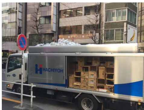
Figura 8.4 Giappone - furgone con cassone adibito al contenimento della merce da trasportare e al di sopra dello stesso gli imballaggi ritirati
