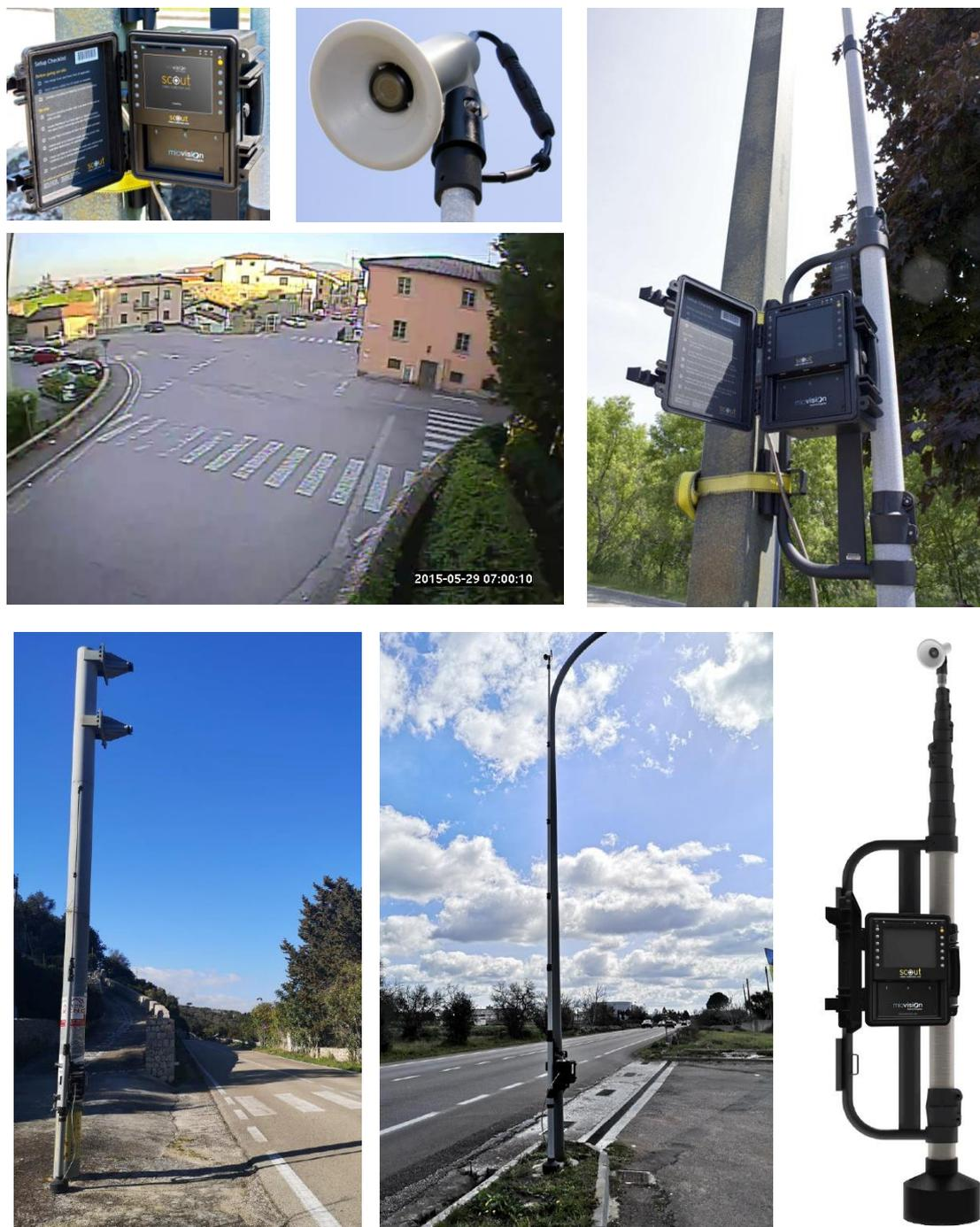
Figura 2.3 Il sistema Miovision per il rilievo dei flussi veicolari
