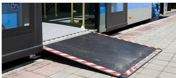
Figura 3.5 Esempio di rampa per accesso ai bus
